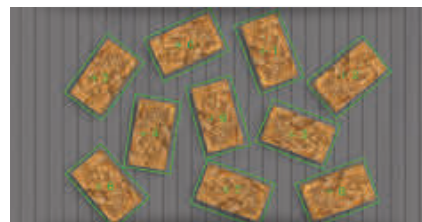
Détection de produit : 10 img avec rotation < 200 ms
