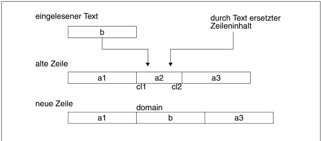
Bild 10: Korrektur einer Zeile mit @UPDATE, Format 1
