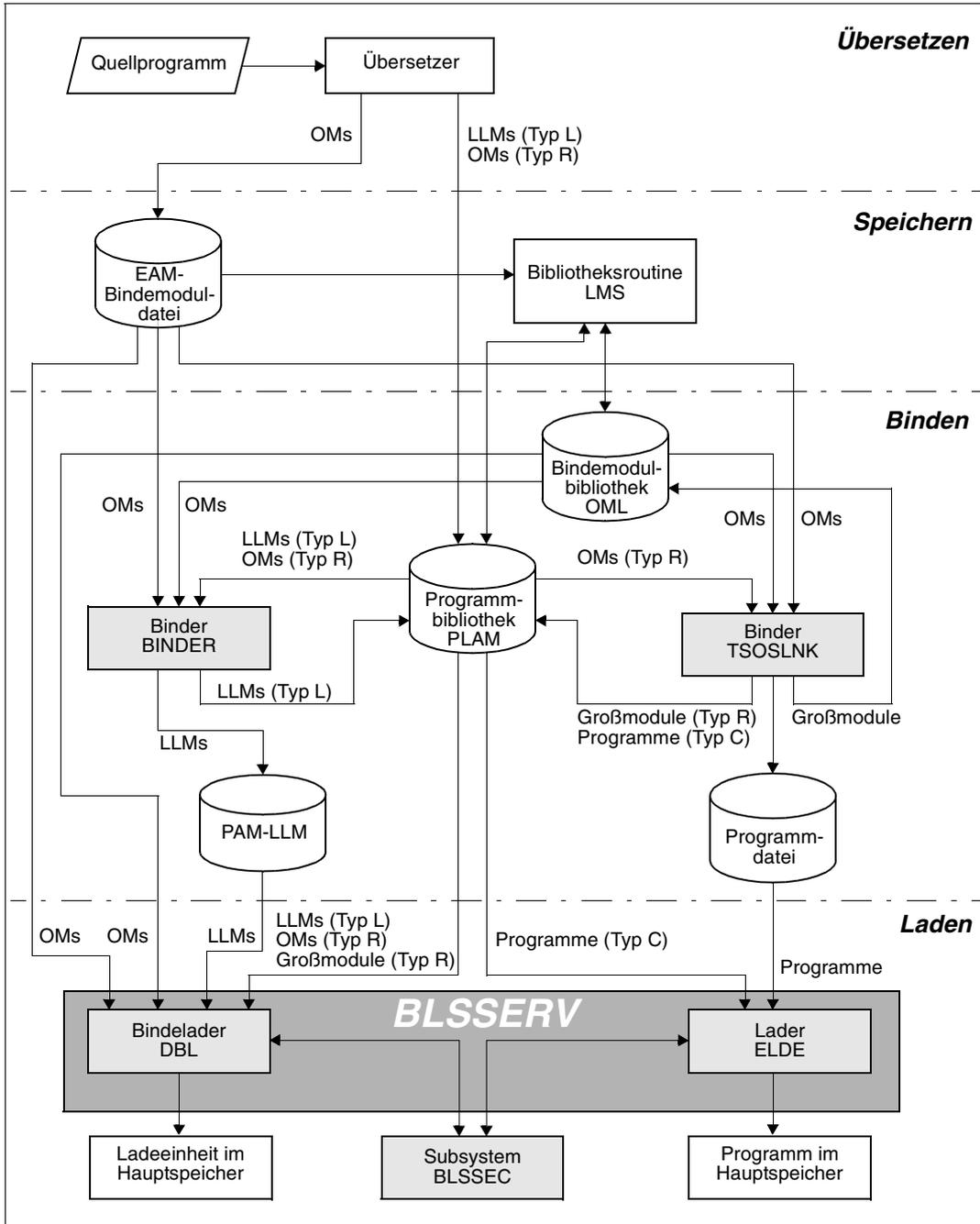
Bild 1: Zusammenwirken der Funktionseinheiten für Binden und Laden
