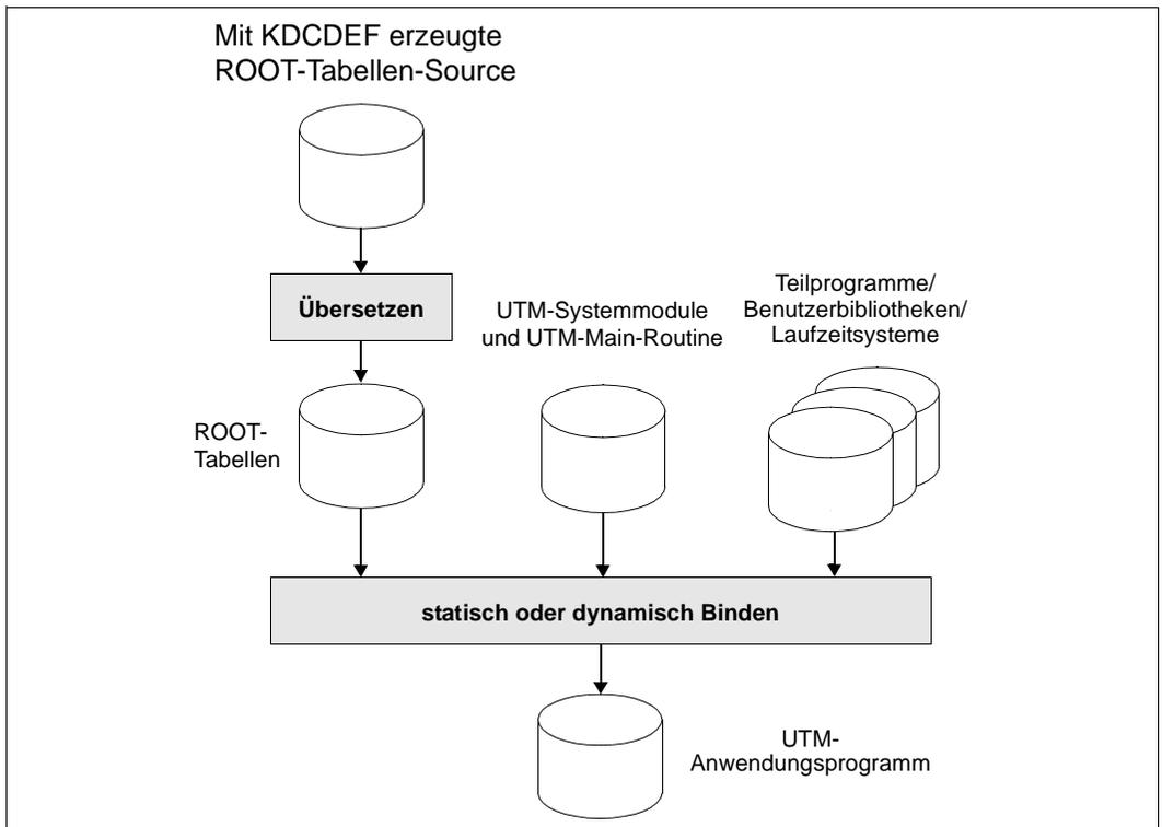
Bild 1: Übersicht: Erzeugen des UTM-Anwendungsprogramms
