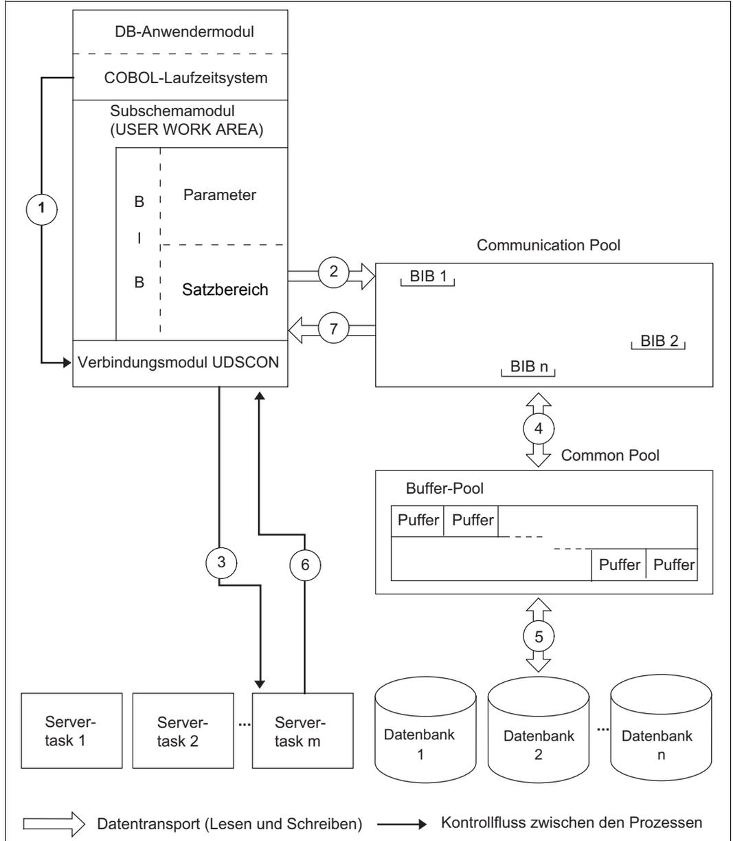
Bild 4: Abwicklung einer COBOL-DML-Anweisung durch den independent DBH
