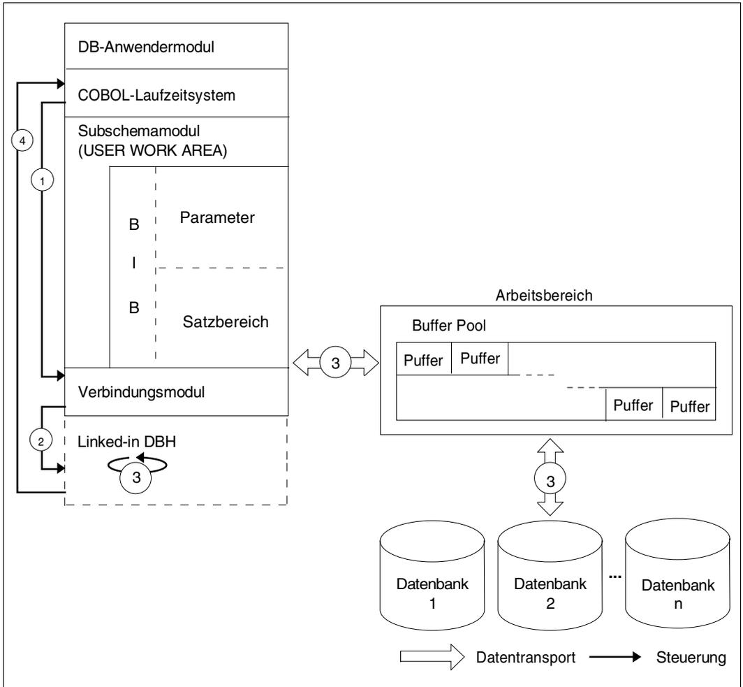
Bild 7: Abwicklung einer COBOL-DML-Anweisung durch den linked-in DBH
