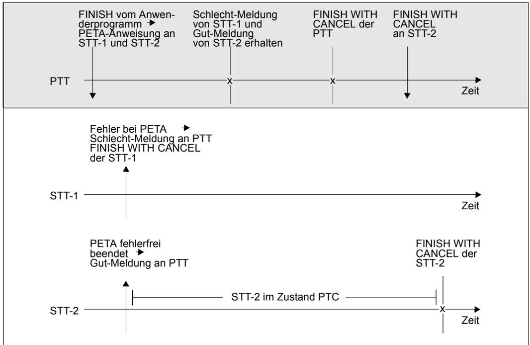
Bild 19: Zeitlicher Ablauf eines gescheiterten Zwei-Phasen-Ende-Protokolls bei UDS-D
