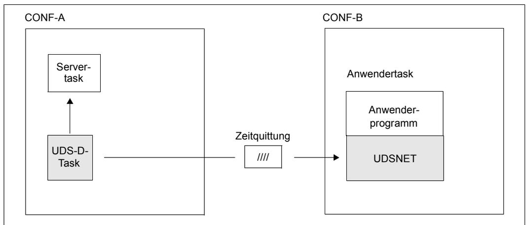
Bild 25: Überwachen der logischen Verbindung zum entfernten Anwenderprogramm
