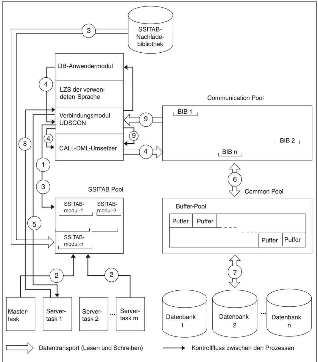
Bild 5: Abwicklung einer CALL-DML-Anweisung durch den independent DBH
