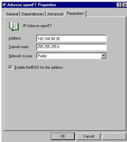
openFT im Cluster konfigurieren: IP Address - Parameters
