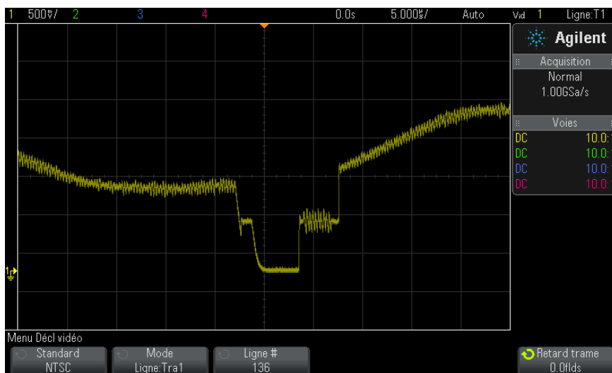
Figure 27 Exemple : déclenchement sur la ligne 136
