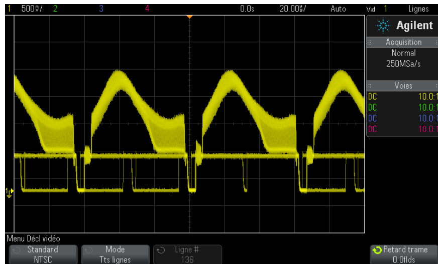
Figure 28 Déclenchement sur toutes les lignes
