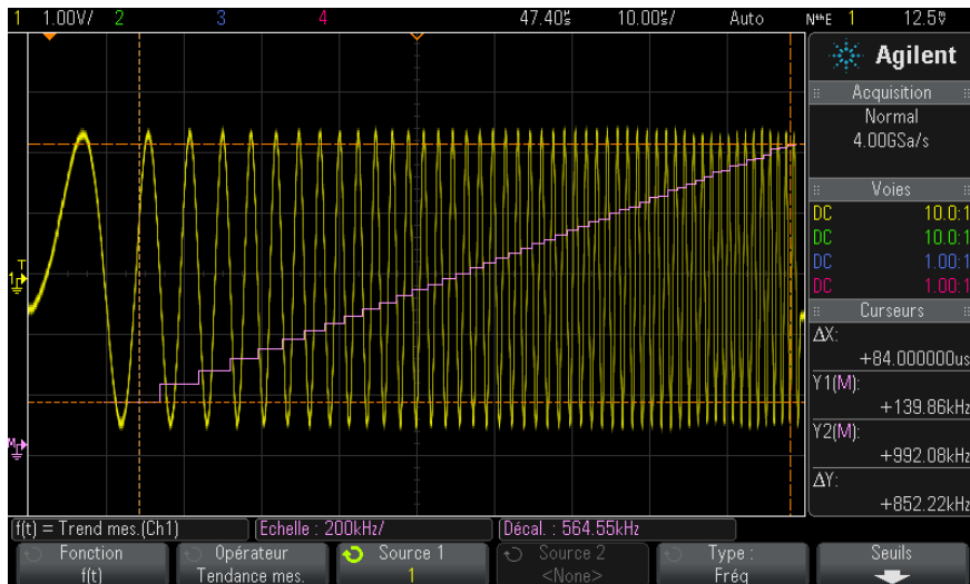
Figure 17 Exemple de tendance de mesure
