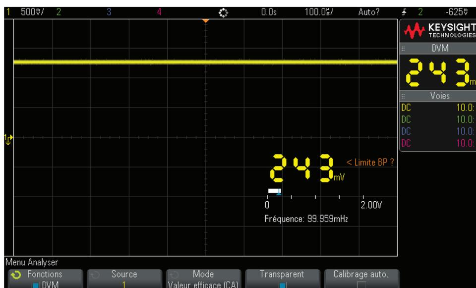
Le DVM permet d'effectuer avec précision des mesures de la valeur efficace vraie lorsque la fréquence du signal est comprise entre 20 Hz et 100 kHz. Lorsque la fréquence de signal est située en dehors de cette plage, "<Limite BP ?" ou ">Limite BP ?" apparaît sur l'écran du DVM pour vous alerter des résultats inexacts de mesure de la valeur efficace vraie.
