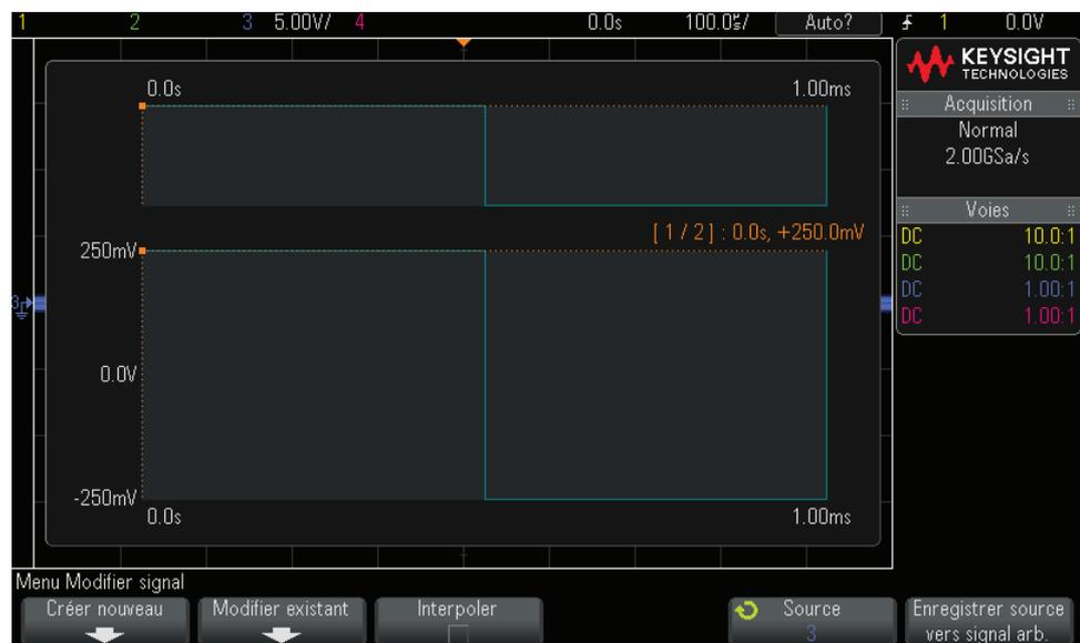
Lorsque vous ouvrez le menu Modifier signal, une définition du signal arbitraire existant apparaît. La tension et la durée que vous voyez apparaître dans le schéma représentent les paramètres limitatifs. Ils proviennent des réglages de fréquence et d'amplitude définis dans le menu principal Générateur de signal.
