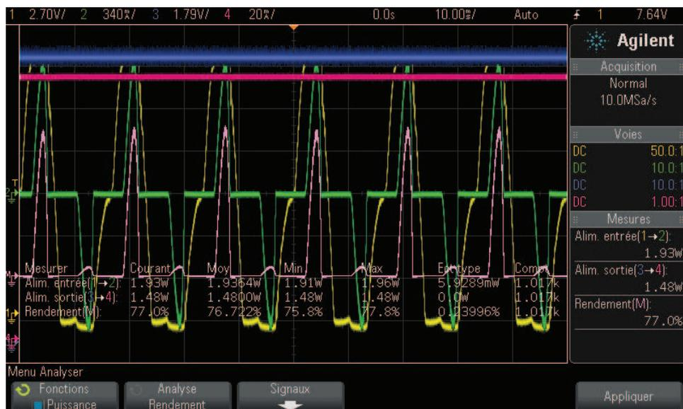
Les signaux de tension d'entrée, de courant d'entrée, de tension de sortie et de courant de sortie sont affichés, ainsi que le signal de puissance d'entrée (signal résultant de la multiplication de la tension et du courant d'entrée). Les mesures automatiques et les statistiques de puissance suivantes sont également affichées :
