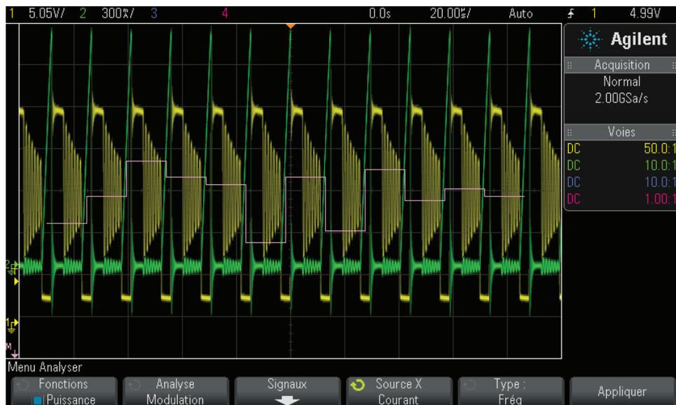
La visualisation de l'opération mathématique Tendence de mesure est utilisée pour représenter la variation des mesures pour chaque cycle des signaux de modulation.
