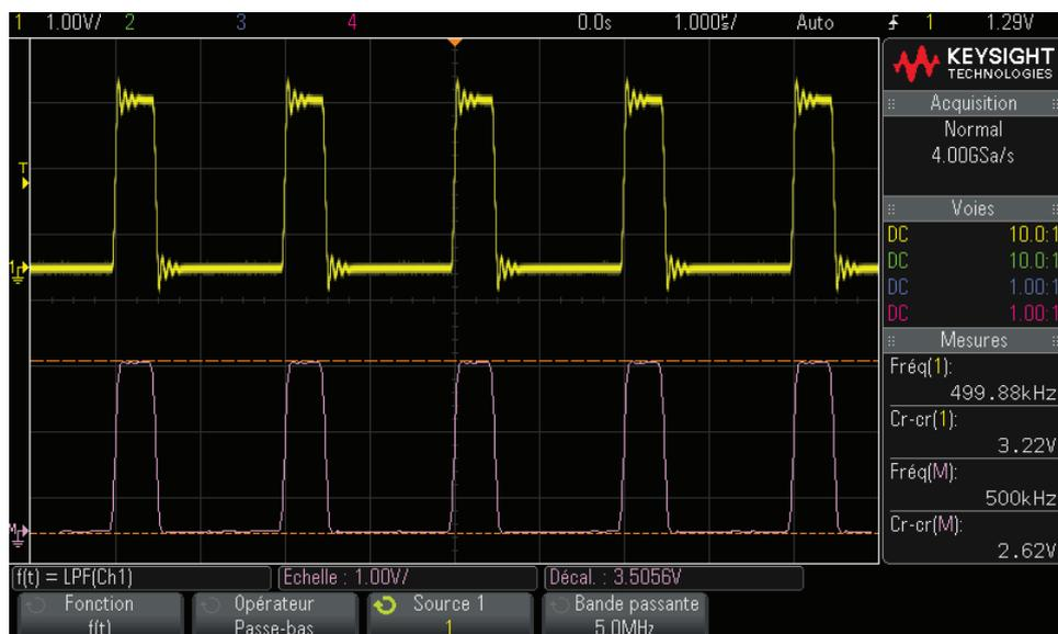
Figure 15 Exemple de filtre passe-bas
