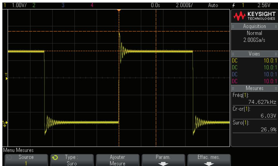
**Figure 46** Mesure automatique de la suroscillation
