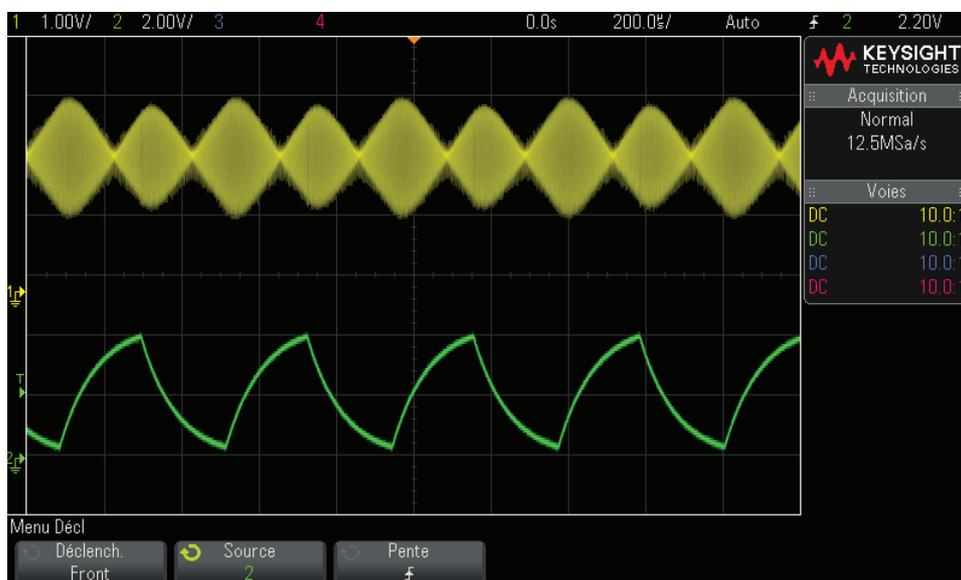
**Figure 26** Modulation d'amplitude représentée à une intensité de 40%
