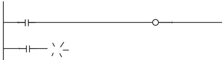
2. Les bits de sortie, les temporisations, les compteurs et les autres instructions de sortie ne peuvent être connectés directement à la barre de bus gauche. Si l'un de ces éléments est connecté directement à la barre de bus gauche, la vérification du programme par un périphérique de programmation mentionnera une erreur d'équation logique. (Le programme peut s'exécuter mais les instructions Out et MOV(021) ne seront pas exécutées.)
