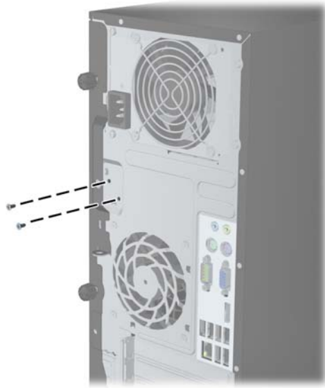
Figure C-2 Retrait des vis du verrou du capot intelligent de l'ordinateur compact
