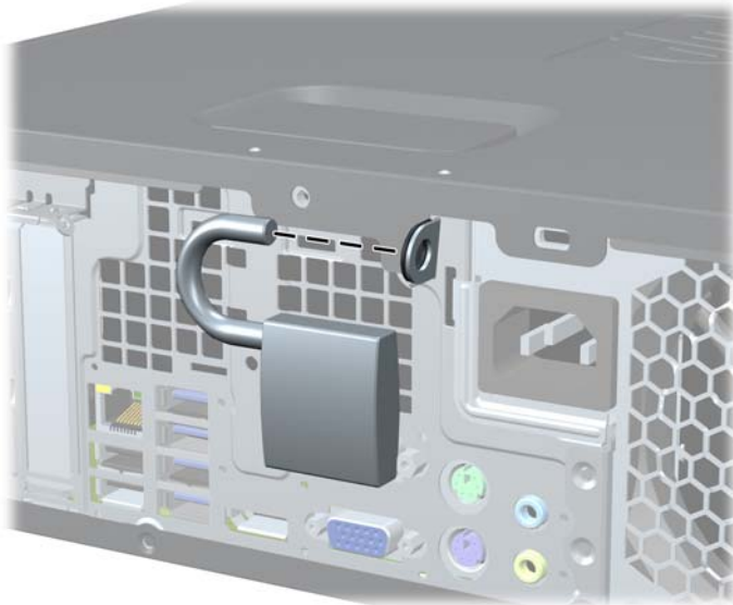
Figure 3-41 Installation d'un cadenas
