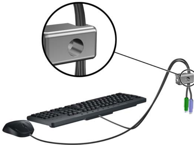
Figure 3-46 Enfilage des câbles du clavier et de la souris
