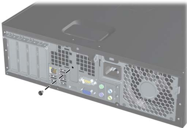
Figure C-2 Retrait des vis du verrou du capot intelligent de l'ordinateur compact
