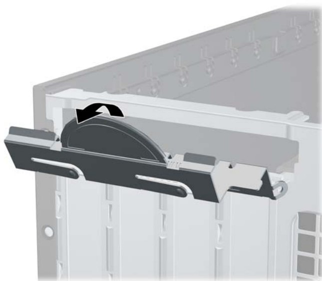
Figure 3-10 Ouverture du dispositif de retenue
