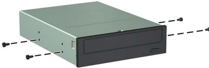
Figure 3-22 Installation des vis de guidage dans l'unité optique
