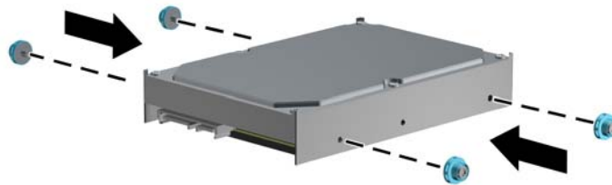
Figure 3-37 Installation des vis de guidage de disque dur
