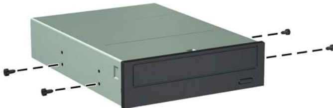
Figure 2-20 Installation des vis de guidage (unité optique illustrée)
