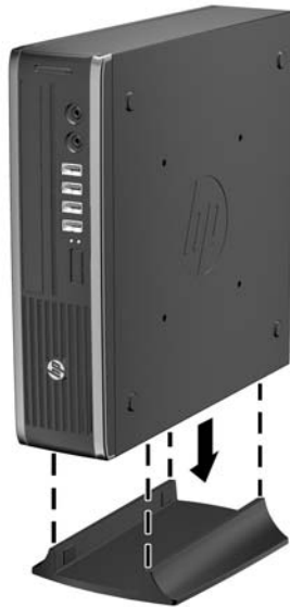
Figure 5-7 Placement de l'ordinateur sur le socle
