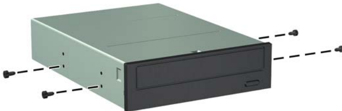
Figure 3-21 Installation des vis de guidage (unité optique illustrée)
