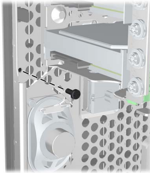
Figure 3-44 Installation de la vis de sécurité du cache avant
