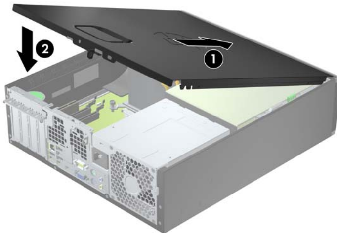
Figure 4-2 Remise en position du panneau d'accès de l'ordinateur
