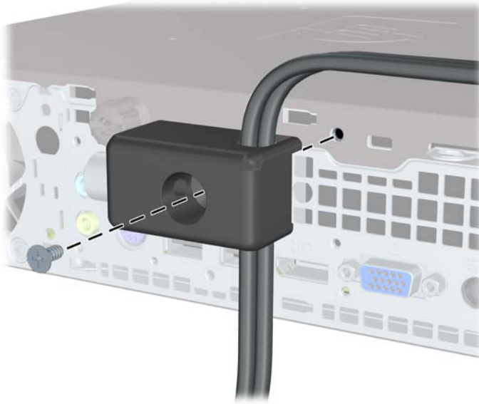
Figure 5-32 Fixation du verrou au châssis
