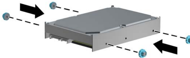
Figure 4-38 Installation des vis de guidage de disque dur
