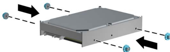
Figure 3-27 Installation des vis de guidage d'isolation sur un lecteur 3,5 pouces
