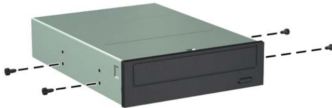
Figure 4-23 Installation des vis de guidage dans l'unité optique (2 de 2)
