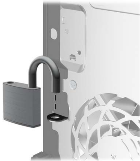
Figure 3-34 Installation d'un cadenas
