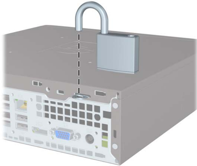
Figure 5-26 Installation d'un cadenas
