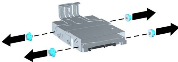
Figure 5-17 Retrait des vis de guidage
