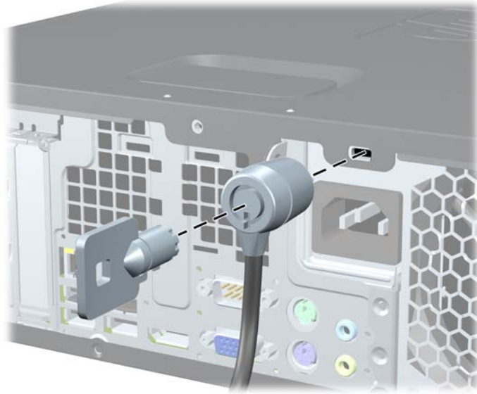
Figure 4-41 Installation d'un câble de sécurité
