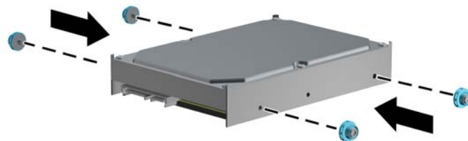
Figure 2-25 Installation des vis de guidage d'isolation sur un disque dur 3,5 pouces
