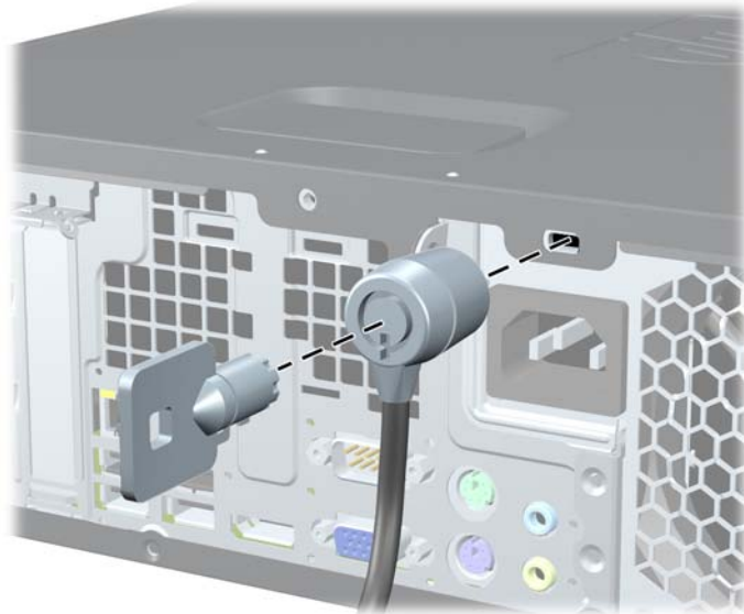
Figure C-1 Installation d'un câble de sécurité
