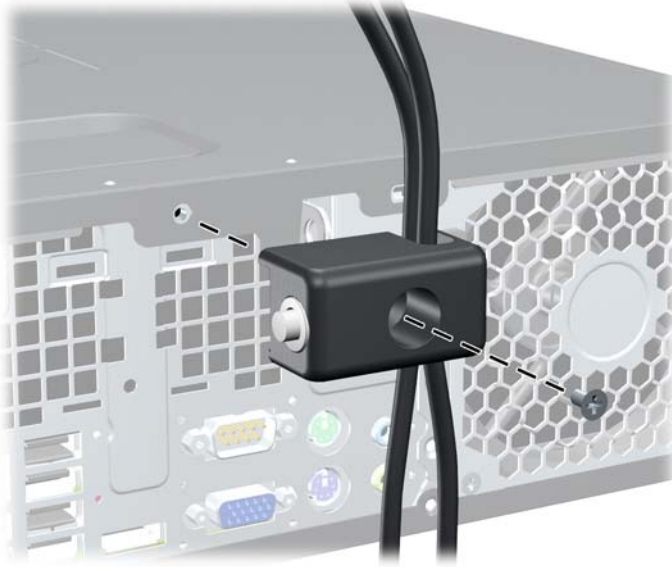
Figure C-5 Fixation du verrou sur le châssis
