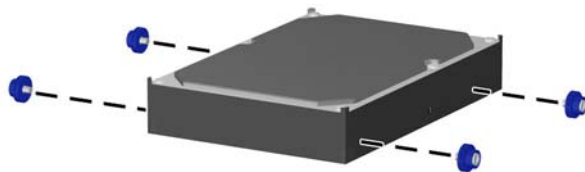
Figure 2-37 Installation des vis de guidage de disque dur
