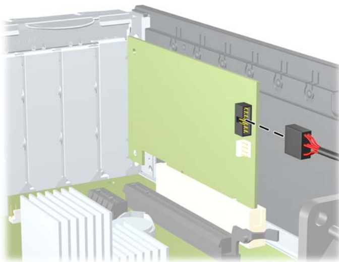
Figure 2-30 Déconnexion du câble 1394 du lecteur de cartes multimédias
