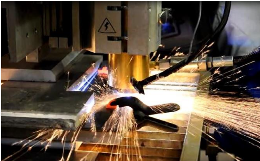
Torche de coupage automatique Akryvia en fonctionnement
