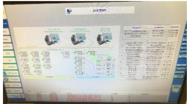
L'ensemble des équipements CVC dialogue sur le réseau LonWorks et le traitement des données est assuré par un poste de supervision GTB situé au RDC.
