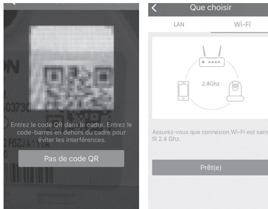
Sobald der Code abgelesen wurde, werden Sie von Ihrem Smartphone oder Tablet aufgefordert, zwischen Lan und WLAN zu wählen. Wählen Sie WLAN und drücken Sie auf "**prêt(e)**" (bereit), geben Sie den Schlüssel des WLAN-Netzes, mit dem Sie verbunden sind, ein, um diesen an die Kamera zu übertragen.
