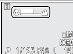
Appuyez sur la commande MF (MF) et faites pivoter le sélecteur de commande jusqu'à ce que le sujet soit net. La position de la mise au point (distance entre le sujet et l'objectif) est indiquée sur le moniteur ou dans le viseur électronique. L'icône **M-F** apparaît sur l'écran de contrôle.
