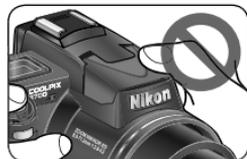
N'essayez pas d'ouvrir le flash intégré manuellement. Vous risquez sinon de l'endommager. Afin de le rentrer, appuyez dessus délicatement jusqu'à ce qu'il s'encliquette en position. N'exercez pas de pression, que ce soit sur l'avant, l'arrière ou les côtés du flash.
