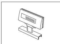
Écran auxiliaire LC/RS-BLD rétroéclairé sur support (incl. câble RS et adaptateur secteur séparé)
