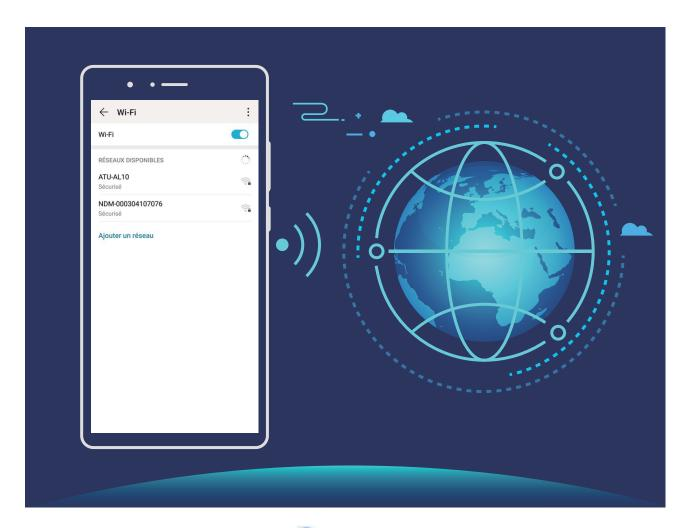
Se connecter à un réseau Wi-Fi : ouvrez Paramètres, allez à Sans fil & réseaux > Wi-Fi et activez Wi-Fi. Touchez un réseau Wi-Fi pour y accéder, et saisissez-en le mot de passe d'accès pour terminer le processus d'authentification ainsi que requis. Alternativement, faites défiler jusqu'en bas le menu, touchez Ajouter un réseau et suivez les instructions à l'écran pour ajouter un point d'accès sans fil en saisissant un nom et mot de passe.
