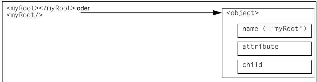
Das XML-Element `myRoot` wird auf ein Objekt abgebildet, bei dem das Attribut `name` mit dem Namen des XML-Elements (`myRoot`) besetzt ist.
