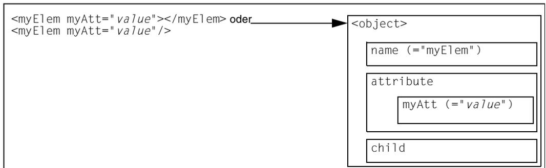
Das XML-Element `myElem` wird auf ein Objekt abgebildet, bei dem das Attribut `name` mit dem Namen des XML-Elements (`myElem`) besetzt ist.
