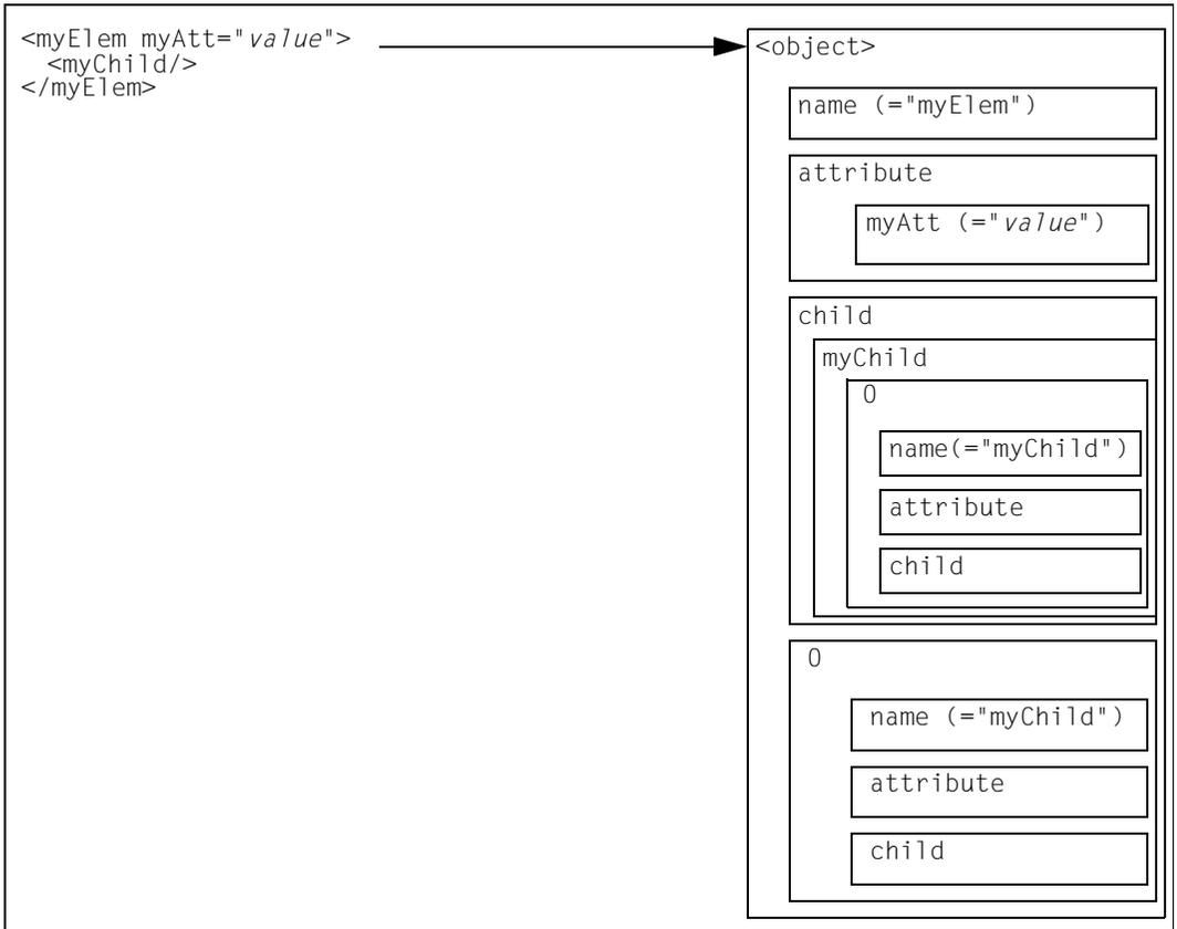
Das XML-Element `myElem` wird auf ein Objekt abgebildet, bei dem das Attribut `name` mit dem Namen des XML-Elements (`myElem`) besetzt ist.
