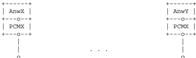
Im CMX hingegen meldet sich der zentrale RFC1006-Protokolltreiber am privilegierten Port 102 von TCP/IP an und empfaengt ueber diesen Port alle ankommenden Verbindungsaufbauten. Die Anwendungen melden sich beim RFC1006-Treiber an und sind von extern ueber den Port 102 adressierbar. Um die Anwendungen unterschieden zu koennen, muessen sie sich mit verschiedenen T-Selektoren anmelden.
