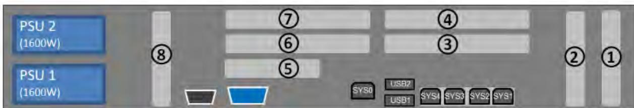
Bild 12: Prinzip der PCIe-Slot-Belegung auf der Geräterückseite (AU47 M5)
