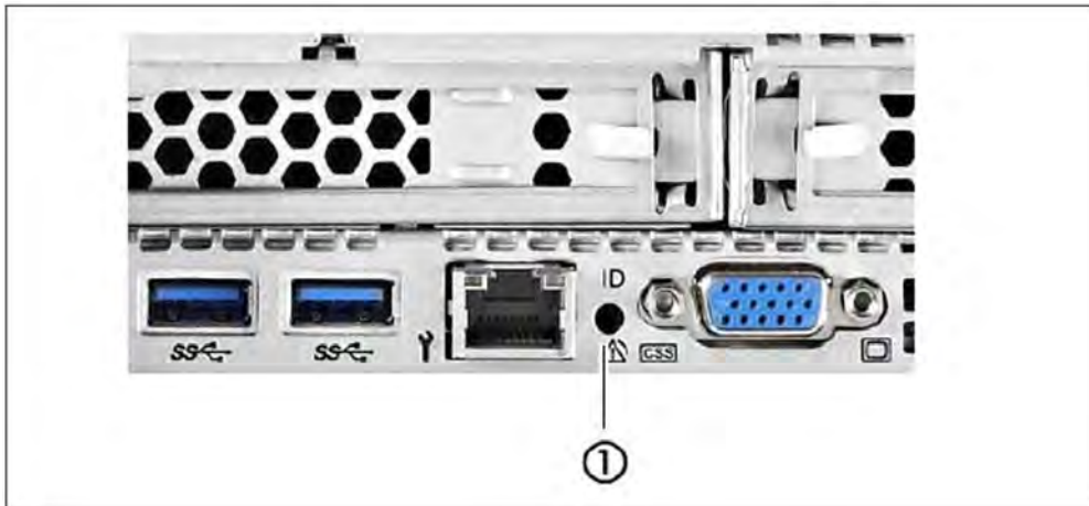
Bild 43: ID-/CSS-/Global-Error-Anzeige (HNC M2)
