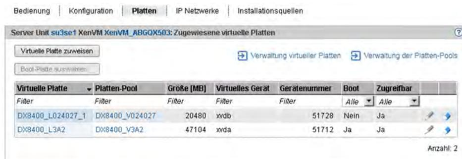
Die Registerkarte *Platten* zeigt die virtuellen Platten an, die aktuell der XenVM zugewiesen sind. Sie können eine virtuelle Platte zuweisen, die Boot-Platte auswählen, die Kapazität einer zugewiesenen Platte ändern oder eine Platte entfernen:
