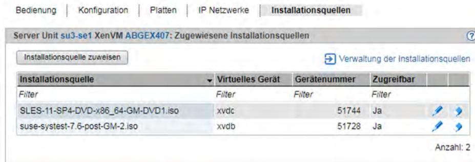
Die Registerkarte *Installationsquellen* zeigt die Installationsquellen der XenVM an. Während eines Installationsvorgangs wird ggf. auch die Installations-Konfigurationsdatei angezeigt. Sie können nachträglich eine Installationsquelle hinzufügen, wechseln oder entfernen:
