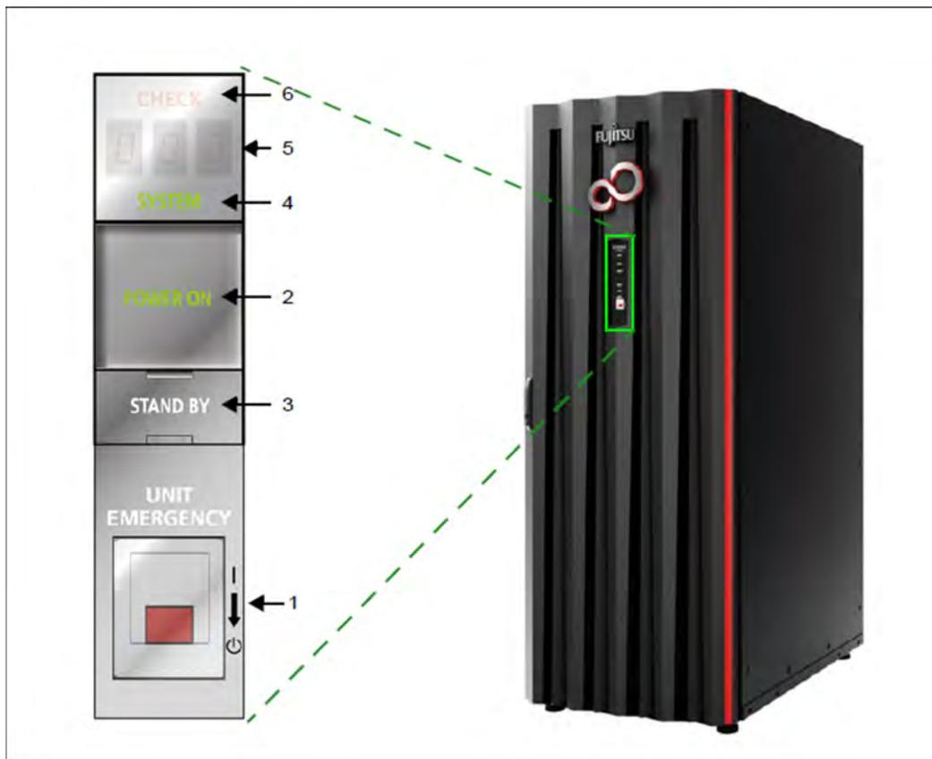
Bild 12: Bedienfeld am Rack des SE700 / SE700B bzw. SE500 / SE500B
