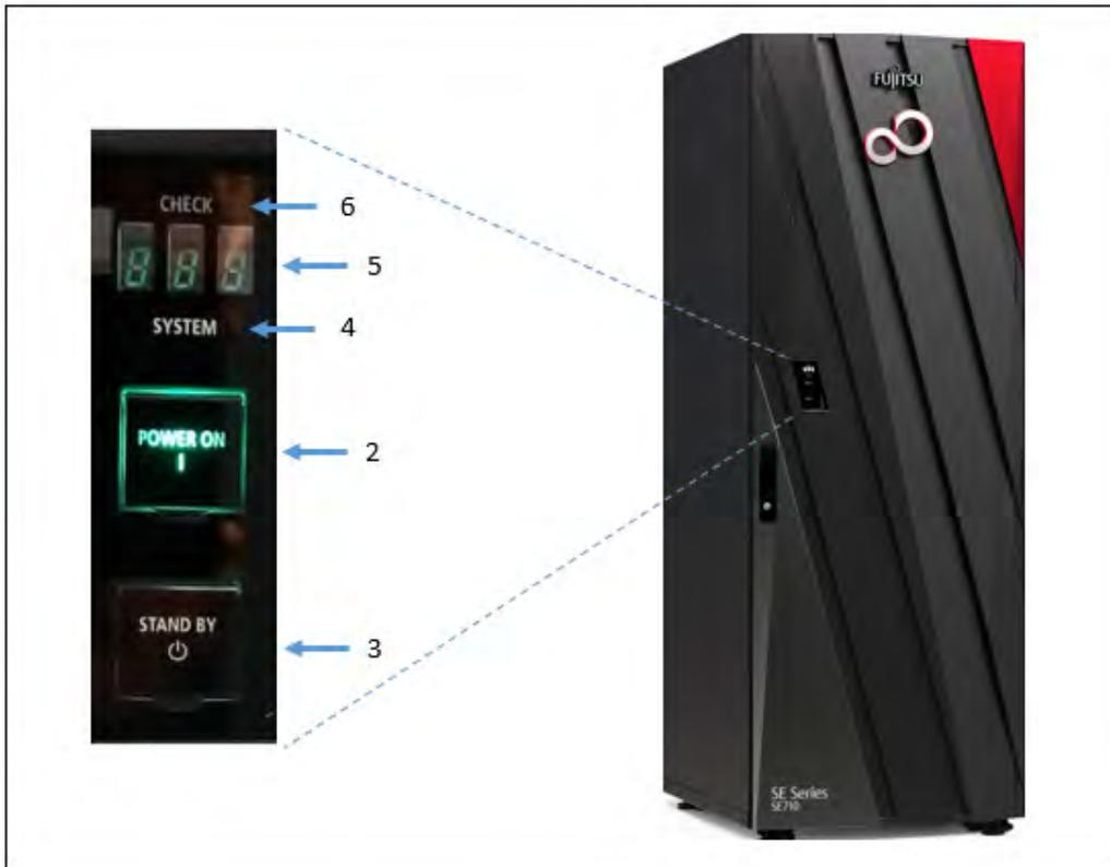
Bild 13: Bedienfeld am Rack des SE710
