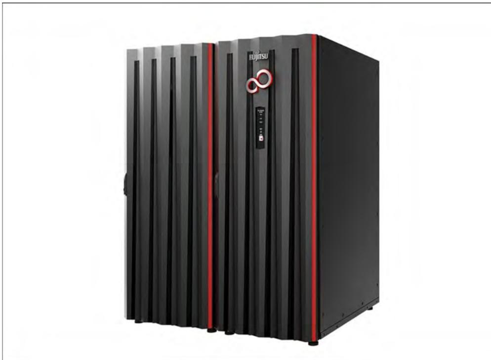
Bild 9: SE Server mit einem Erweiterungs-Rack (z.B. SE700 bzw. SE700B)
