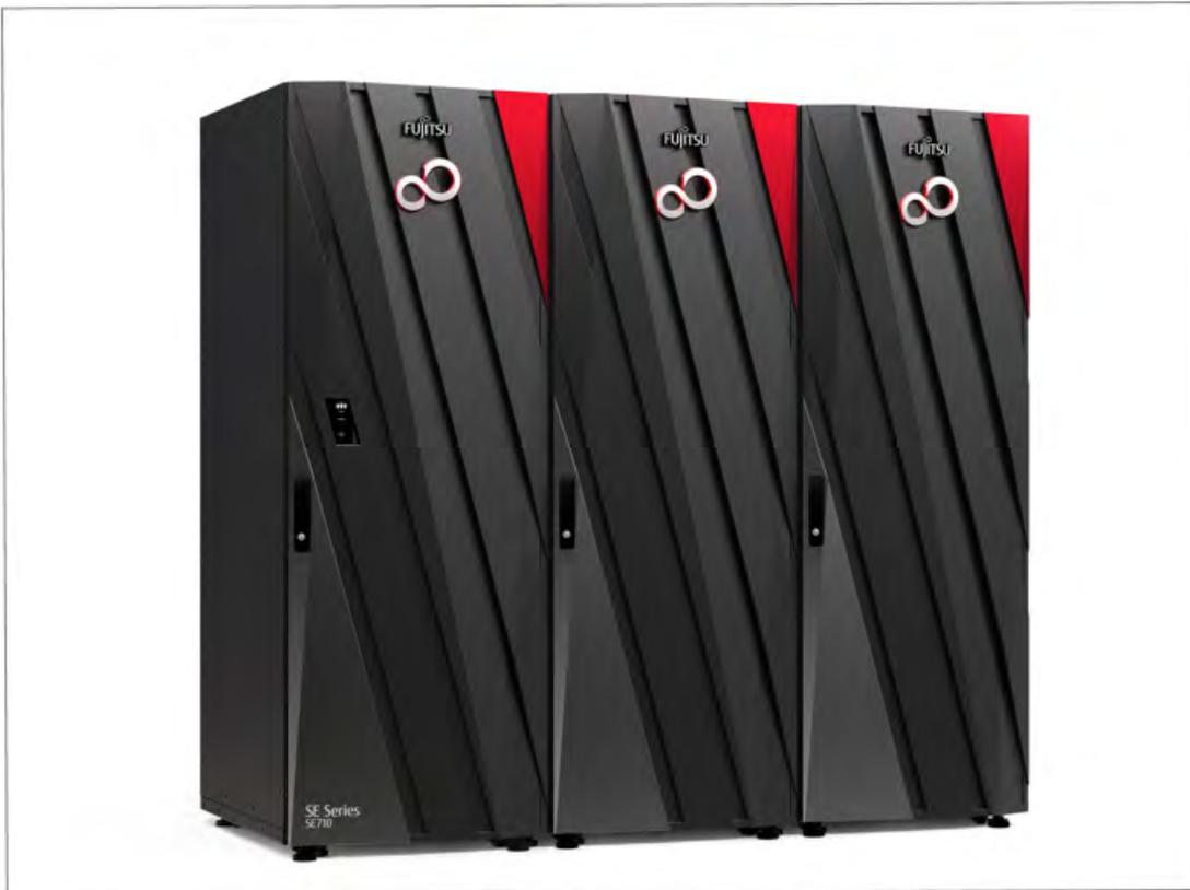
Bild 10: SE710 mit zwei Erweiterungs-Racks
