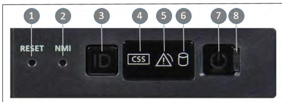
Bild 18: Anzeigen und Bedienelemente am Front Panel der MU M3
