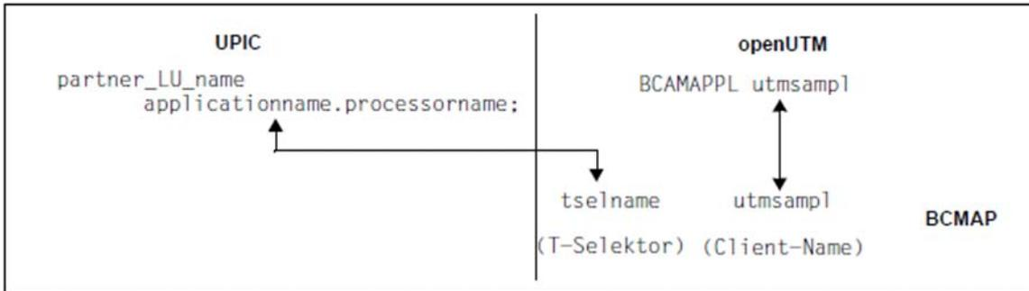
*applicationname* muss mit dem T-Selektor des BCMAP-Eintrags für die UTM-Anwendung am fernen Rechner übereinstimmen.
