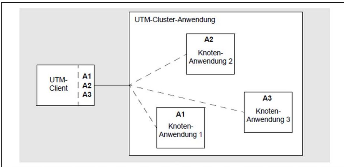
Bild 6: Kommunikation mit einer UTM-Cluster-Anwendung
