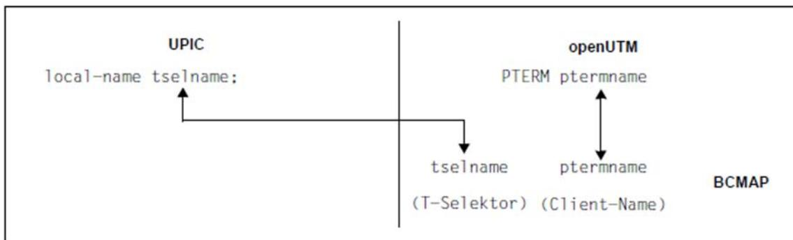
Der T-Selektor der lokalen Anwendung muss mit dem T-Selektor übereinstimmen, der der Client-Anwendung im Server-System zugeordnet ist.
