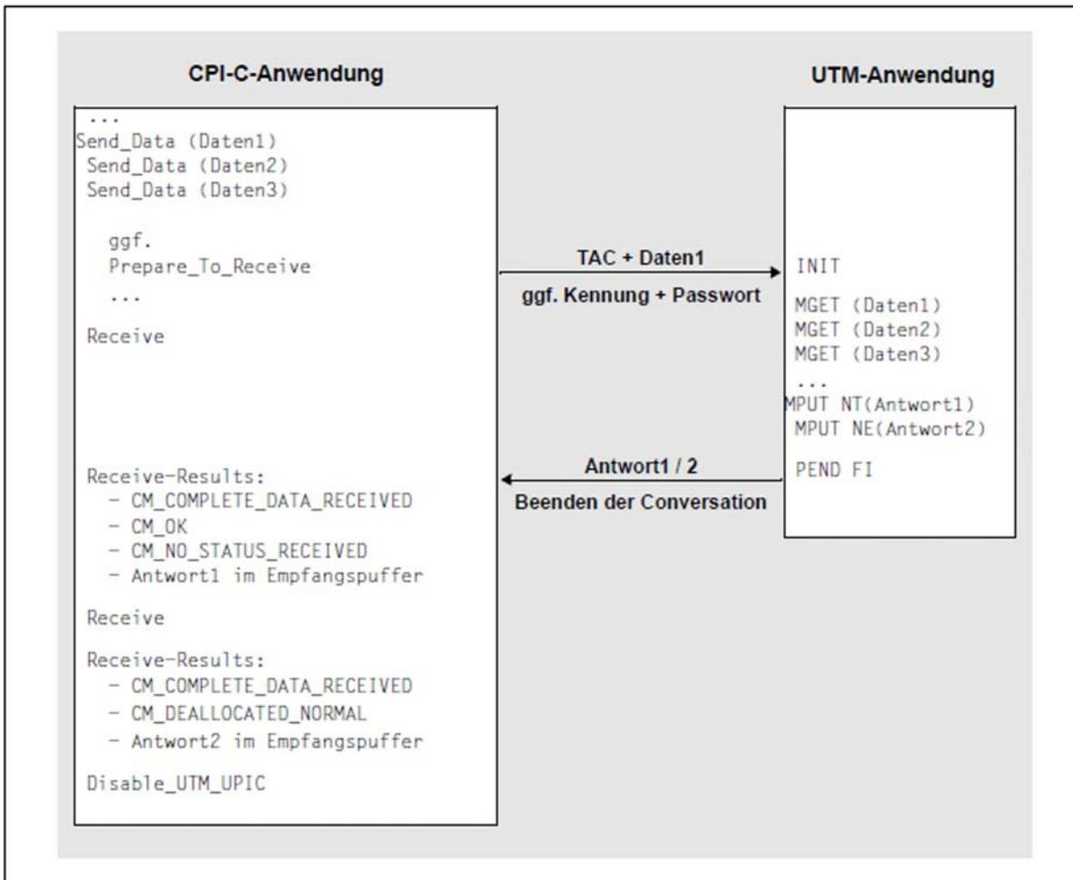
Bild 12: Einschritt-Vorgang mit mehreren *Send-/Receive*-Aufrufen
