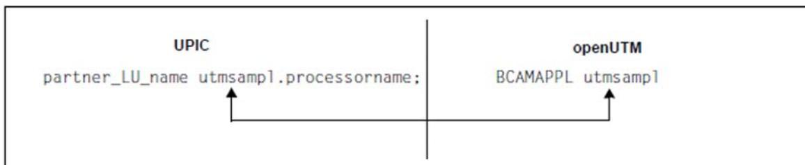
Der *applicationname*, den UPIC an das Transportsystem übergibt, muss dann mit dem BCMAPAPPL-Namen der UTM-Anwendung übereinstimmen, über den die Verbindung mit dem Client aufgebaut wird (im Bild *utmsamp1*). *processorname* muss im TCP/IP Name Service als Name des fernen Rechners eingetragen sein.
