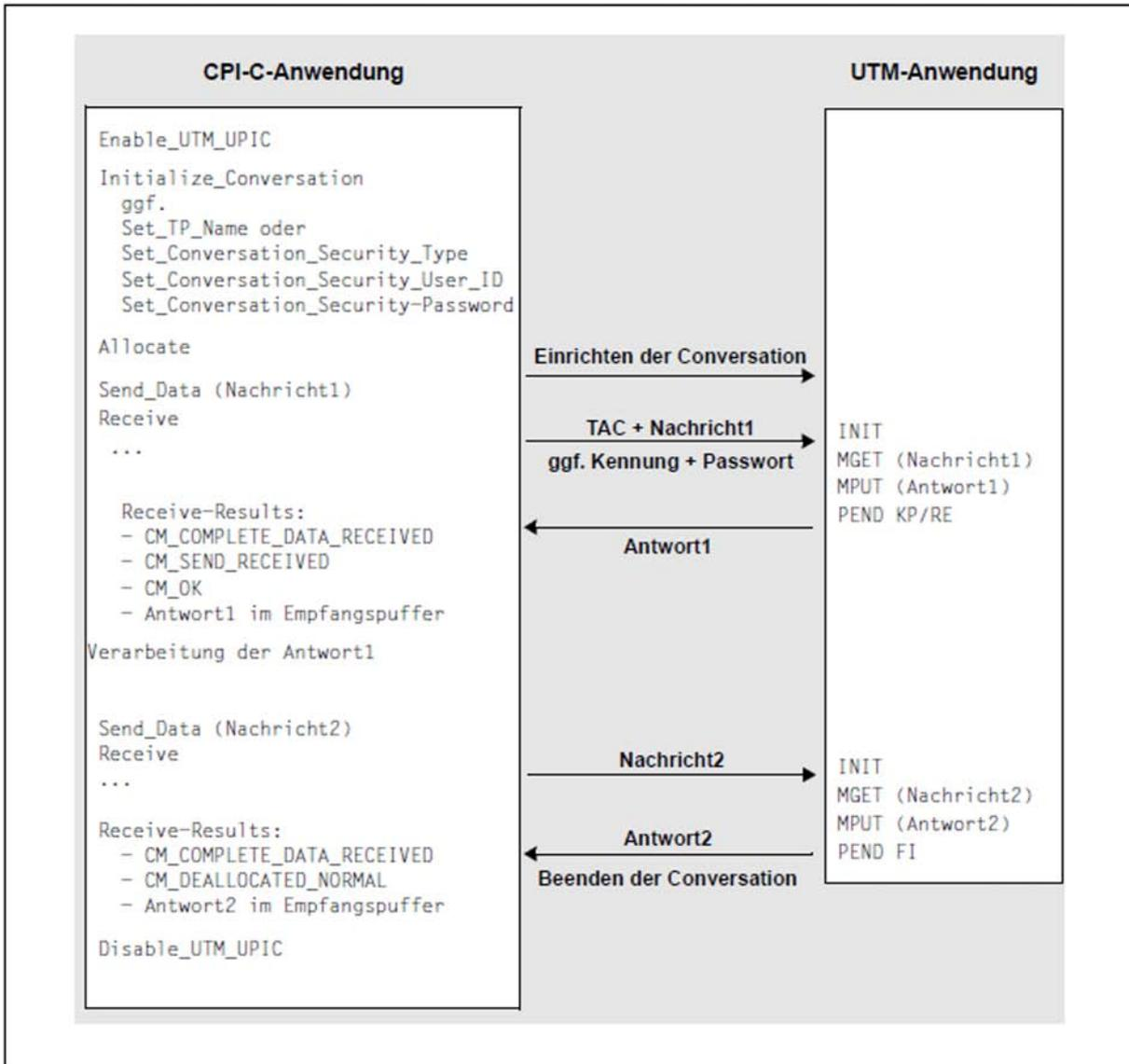
Bild 13: Mehrschritt-Vorgang
