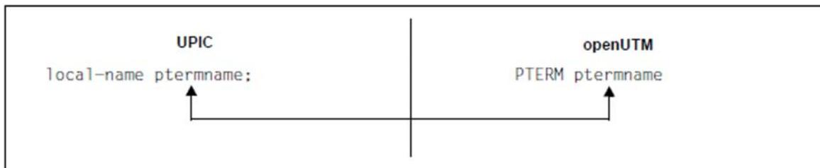
Die beiden PTERM-Namen müssen übereinstimmen. Ist kein PTERM-Name für den Client generiert, dann muss ein LTERM-Pool generiert sein, über den sich der Client anschließen kann.
