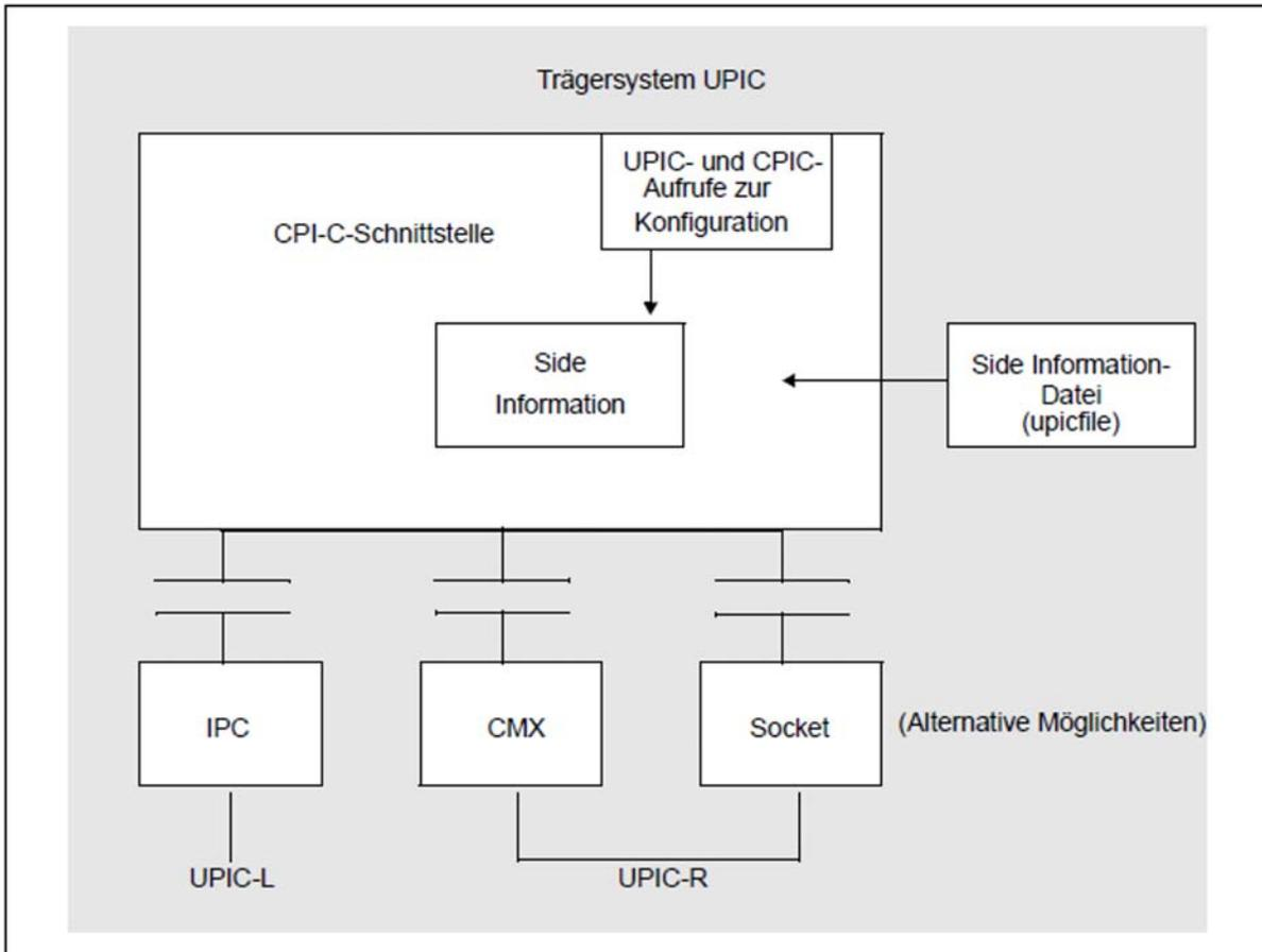
Bild 24: Konfiguration mit und ohne Side Information-Datei
