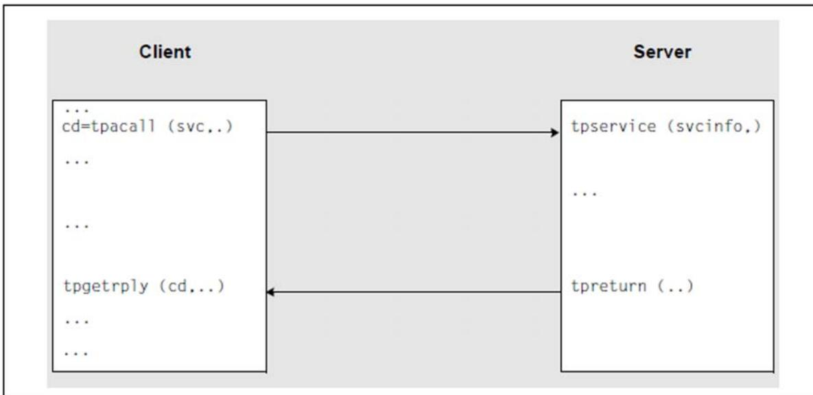
Bild 18: Asynchrones Request-Response-Modell
