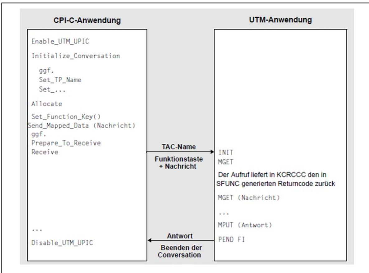
Bild 10: Betätigen einer Funktionstaste in der UTM-Anwendung
