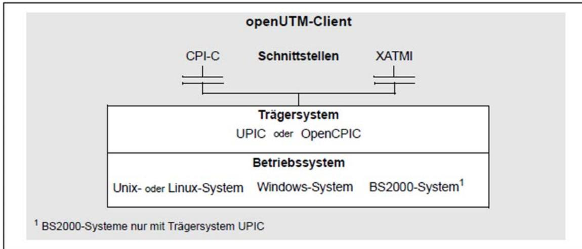
Bild 1: Standardisierte X/Open-Schnittstellen
