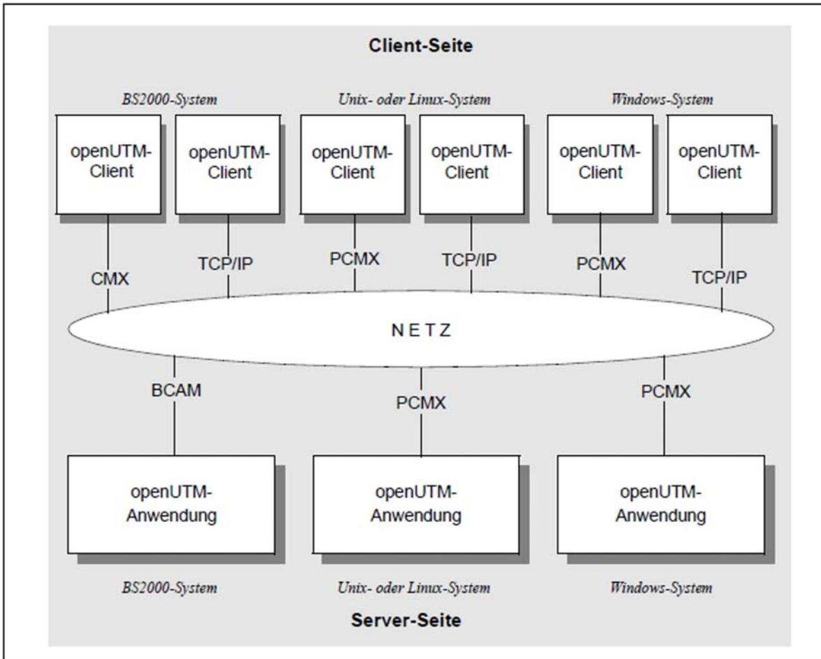
Bild 3: Remote-Anschluss an UTM-Anwendungen
