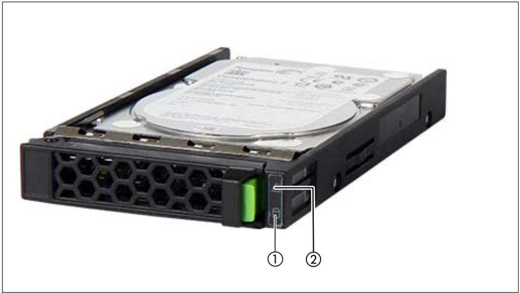
Bild 3: Anzeigen an einem Hot-Plug-HDD-Modul
