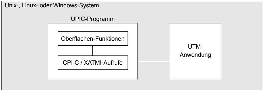
X/W Bild 5: Lokaler Anschluss an eine UTM-Anwendung
