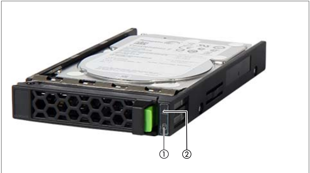
Bild 3: Anzeigen an einem Hot-Plug-HDD-Modul
