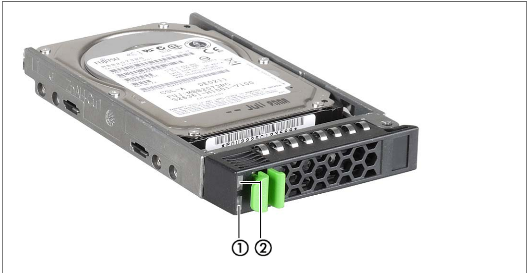
Bild 38: Frontseite - Detailansicht: Anzeigen an einem Festplattenmodul
