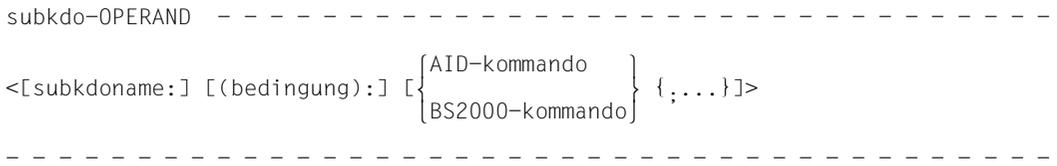
Ein Subkommando kann einen Namen, eine Bedingung und einen Kommandoteil enthalten. Zu jedem Kommando gehört ein Durchlaufzähler. Der Kommandoteil kann aus einem einzelnen Kommando oder einer Kommandofolge bestehen, er kann AID- und BS2000-Kommandos und Kommentare enthalten.
