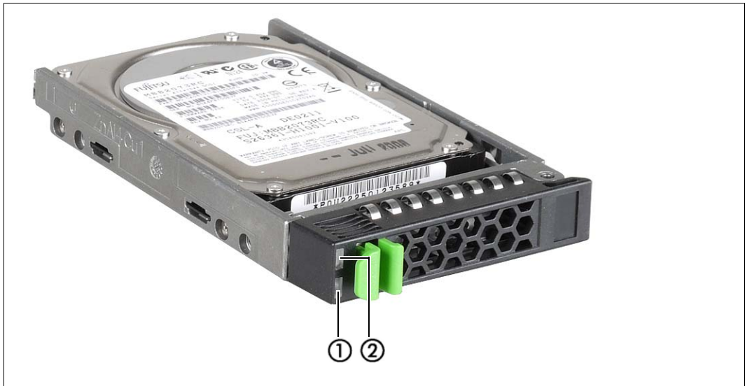
Bild 37: Frontseite - Detailansicht: Anzeigen an einem Festplattenmodul
