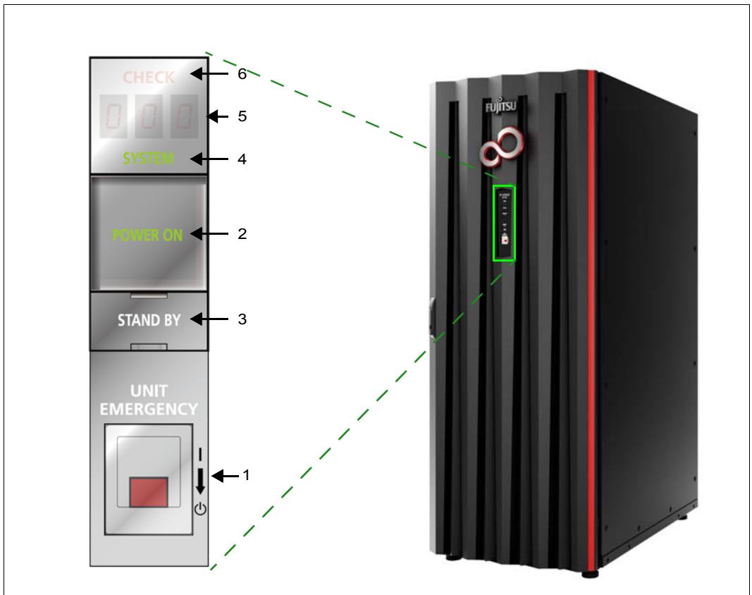
Bild 7: Bedienfeld am Rack des SE700 bzw. SE500
