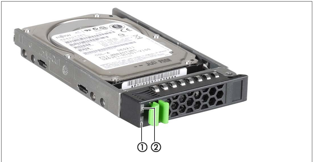
Bild 11: Frontseite - Detailansicht: Anzeigen an einem Festplattenmodul
