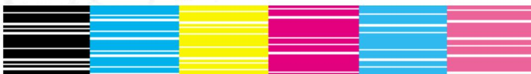
Si l'impression de la page de vérification des buses n'est pas satisfaisante, c'est que l'imprimante présente un problème. Il peut s'agir d'une buse bouchée ou d'une tête mal alignée. Reportez-vous à la section [Nettoyage de la tête d'impression](#) pour avoir des détails sur le nettoyage de la tête d'impression. Pour avoir plus d'informations sur l'alignement de la tête d'impression, reportez-vous à la section [Alignement de la tête d'impression](#).
