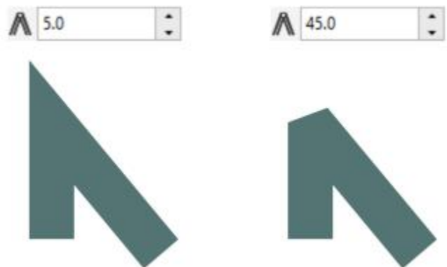
Lignes se croisant dans le même angle aigu. À gauche : L'angle est supérieur à la limite des sommets, créant un angle pointu. À droite : L'angle est inférieur à la limite des sommets, créant un angle biseauté.
