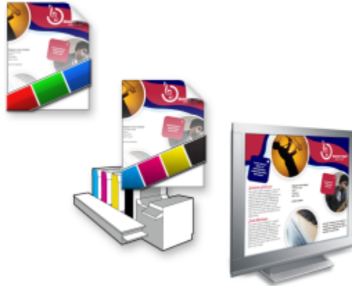
Gauche (haut) : un profil de couleurs RVB est affecté au document. Centre et droite : Si vous affectez un profil CMJN précis, vous pouvez simuler la sortie imprimée à l'écran.
