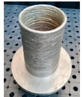
↑ Figure 1 : exemple de pièce en acier inoxydable austénitique fabriquée par procédé TIG.
