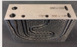
→ Insert de moules [acier Maraging]. INDUSTRIE
