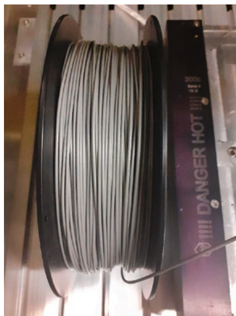
Fabrication de fil pour imprimante de type fondu (FDM) à base d'un mélange polycarbonate/acrylonitrile butadiène styrène, issu du traitement des déchets d'équipements électriques et électroniques.
