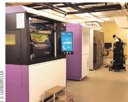
Figure 2 : Exemple de moyen en fabrication additive par fusion laser sur lit de poudre : machine FormUp350 de la société AddUp.
