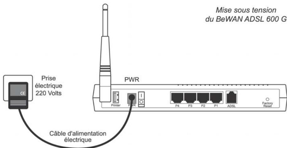
La mise sous tension du routeur suppose également le positionnement de l'interrupteur sur **ON**.
