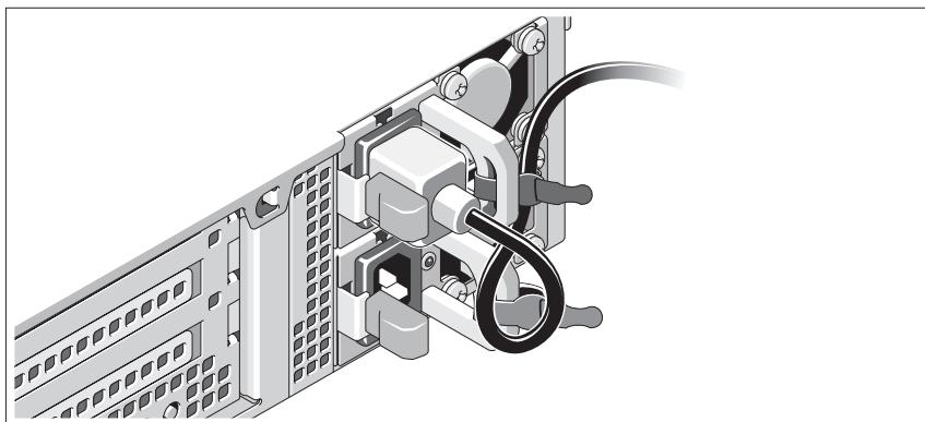
Repliez le câble et faites-le passer dans le clip comme la figure le montre, puis fixez-le à l'aide de la sangle fournie. Branchez ensuite l'autre extrémité du câble d'alimentation sur une prise secteur mise à la terre ou sur une source d'alimentation autonome (onduleur ou unité de distribution de l'alimentation).
