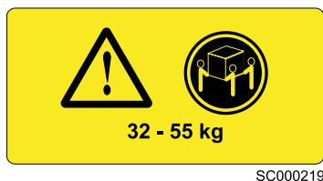
Obrázek 19. Systém 2104 model TS4 - štítek s hmotností
