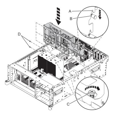
Figure 43. Installing the fan cage
