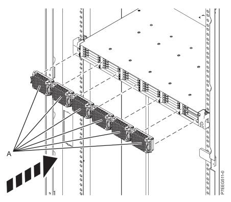
Figure 18. Installing the SSD EMC bezels
