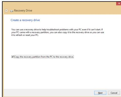
Assurez-vous que **Copy contents from the recovery partition to the recovery drive** (Copier le contenu de la partition de récupération sur le disque de récupération) est sélectionné. Cela fournit la sauvegarde de récupération la plus complète et la plus sûre.
