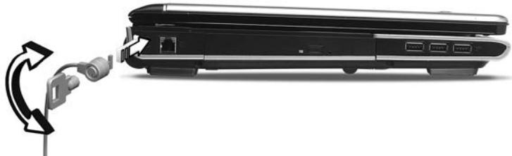
Enroulez le câble du cadenas de sécurité pour ordinateur autour d'une table, de la poignée d'un tiroir verrouillé, ou de tout autre objet fixe. Insérez le cadenas dans l'encoche et tournez la clef pour verrouiller le cadenas. Certains modèles ne possèdent pas de clef.
