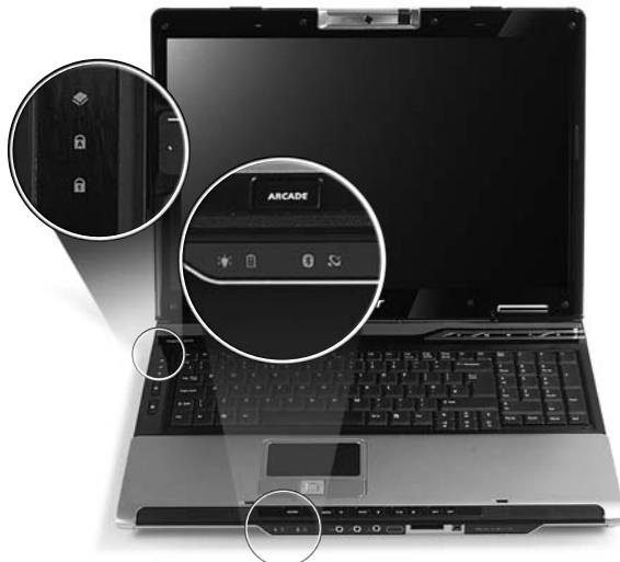
Les indicateurs d'état de l'alimentation, de la batterie et de la communication sans fil sont visibles même lorsque l'écran LCD est fermé.
