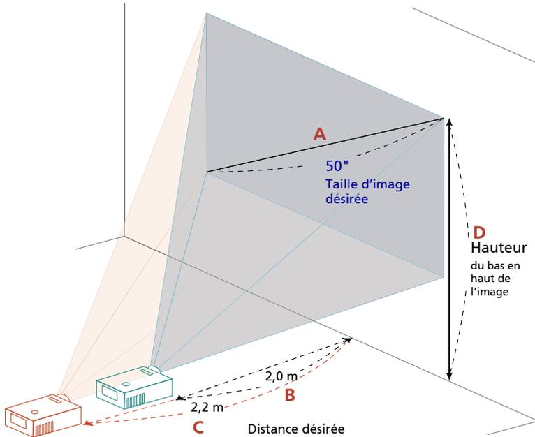
Le tableau ci-dessous explique la façon d'obtenir une taille d'image désirée en réglant soit la position soit la bague de réglage du zoom. Par exemple : Pour obtenir une taille d'image de 50 pouces, réglez le projecteur sur une distance de 2,0 m à 2,2 m de l'écran et réglez le niveau du zoom en fonction.
