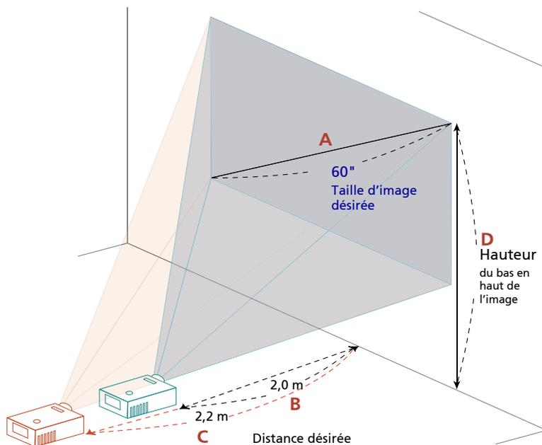
Le tableau ci-dessous explique la façon d'obtenir une taille d'image désirée en réglant soit la position soit la bague de réglage du zoom. Par exemple : Pour obtenir une taille d'image de 60 pouces, réglez le projecteur sur une distance de 2,0 m à 2,2 m de l'écran et réglez le niveau du zoom en fonction.
